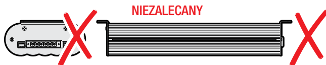
RYSUNEK 2.2.1.3: NIE należy montować urządzenia do góry nogami.
